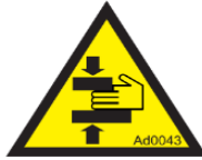
Figure 77 : danger d'écrasement et de cisaillement.
