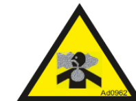
Figure 54 : risque de gaz d'échappement.
