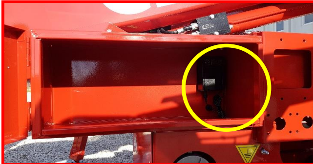
Figure 10 : chargement de la pile de radiocommande.
